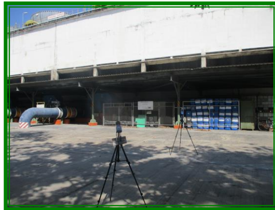
ภาพถ่ายการตรวจวัดระดับเสียงในสถานที่ทำงาน บริเวณอาคาร WHG 3, 4, 5 (Cooling Tower)
